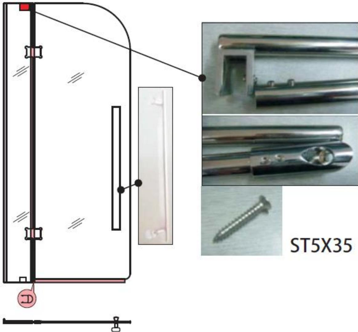
**D. Montieren Sie die Türscharniere. Schrauben Sie an die Glasplatte und an die Glastür.**
