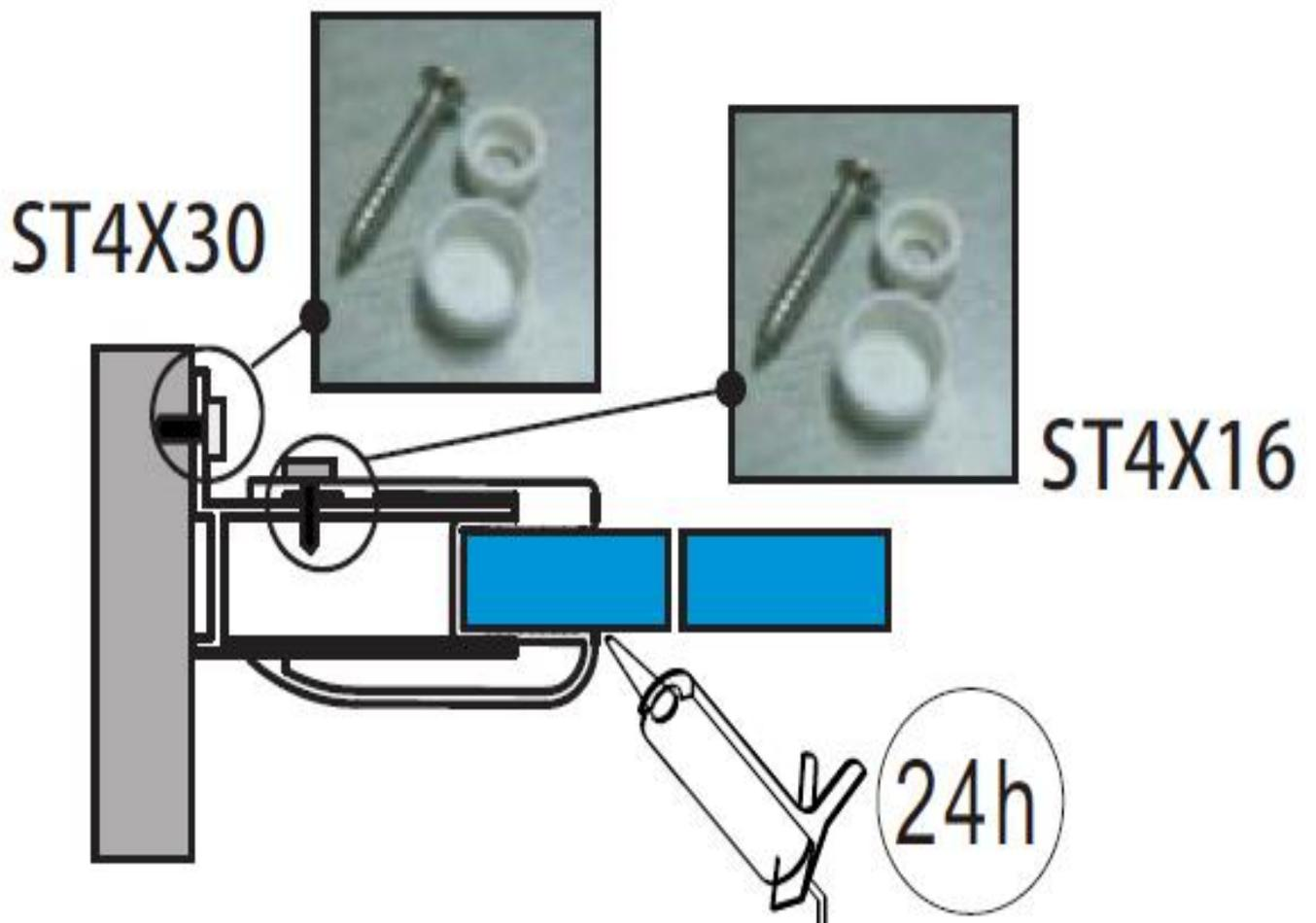
**B. Fixieren Sie die Glasklemme auf der Wannenkante, und verwenden Sie diese Glasklemme Clips für das Glas**
