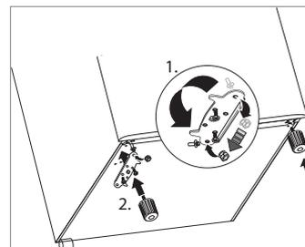
13. Schrauben Sie die Scharnierplatte auf der gegenüberliegenden Seite fest. Achten Sie darauf, dass sich der Scharnierbolzen in der Scharnierbuchse der Tür befindet. Die Tür ist jetzt wieder funktionsfähig.
