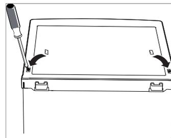
9. Kippen Sie den Gefrierschrank nach hinten (maximal 45 °), damit Sie auch das untere Türscharnier umsetzen können.
