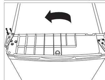
7. Legen Sie die Abdeckung wieder auf den Gefrierschrank zurück, sodass der Temperaturregler **1** wieder in die dafür vorgesehene Öffnung passt. Drücken Sie an beiden Seiten vorne links und rechts auf die Abdeckung, bis sie einrastet.
