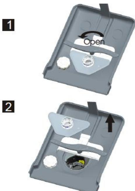
Schritt 1 und 2: Drehen Sie den Siebzylinder gegen den Uhrzeigersinn und heben das Sieb.
