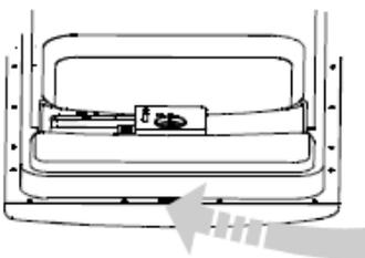
Zum Reinigen der Türumrandung ein weiches, warmes Tuch verwenden. Zum Verhindern, dass Wasser in die Türverriegelung und die elektrischen Elemente eindringt, niemals Sprühreiniger oder ähnliches verwenden.
