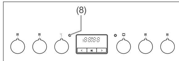
Die rote Backofen-Leuchte (8) leuchtet, sobald Sie eine Beheizungsart gewählt und die Temperatur eingestellt haben. Sie leuchtet, solange der Backofen auf- bzw. nachheizt. Wenn sie das erste Mal erlischt, ist die eingestellte Temperatur im Backofen erreicht.
