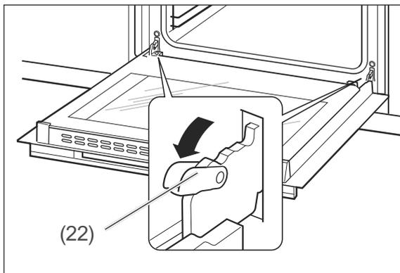
2. Klappen Sie an beiden Seiten die Bügel (22) ganz nach vorne. Nehmen Sie gegebenenfalls einen Schraubendreher zu Hilfe.
