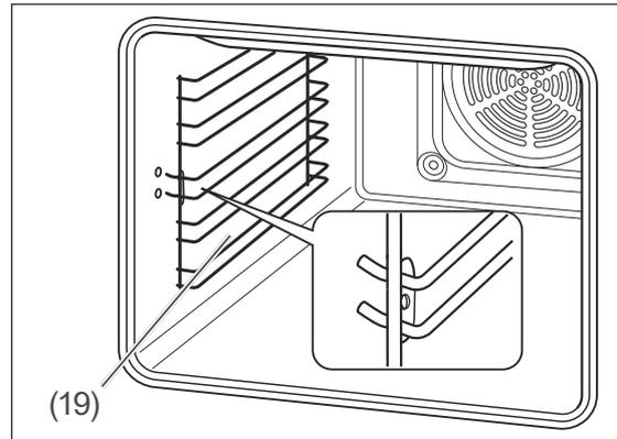
2. Um den Backblechträger (19) zu entfernen, ziehen Sie zuerst die vordere Halterung an der vorderen Seite, an der die beiden Haken mit dem angeschweißten Plättchen sind, mit einem Ruck heraus. Ziehen Sie danach die hintere Halterung des Backblechträgers heraus. Wiederholen Sie den Schritt für den Backblechträger auf den anderen Seite.
