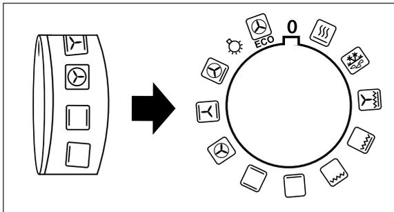
Mit dem Funktionsschalter (12) schalten Sie den Backofen ein und wählen die Beheizungsart aus. Die Backofenbeleuchtung wird eingeschaltet.
