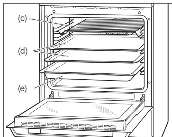
Die mitgelieferten Backbleche (d) und die Fettpfanne (e) haben eine schräge Kante. Nach dem Einschieben sollte diese Kante vorne liegen. Der Grillrost (c) muss wie abgebildet eingeschoben werden.
