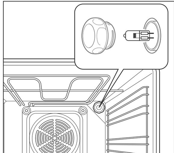
3. Schrauben Sie die Glasabdeckung gegen den Uhrzeigersinn ab und nehmen Sie sie heraus.
