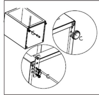
6. Das untere Scharnier lösen, den Stift herausziehen, das Scharnier um 180° drehen und den Stift wiedereinsetzen.
