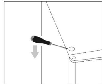
2. Mit einem Schraubenzieher das obere Scharnier lösen.
