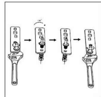
9. Das obere Scharnier fixieren und den Stift in die Aushöhlung der Gerätetür stecken.
