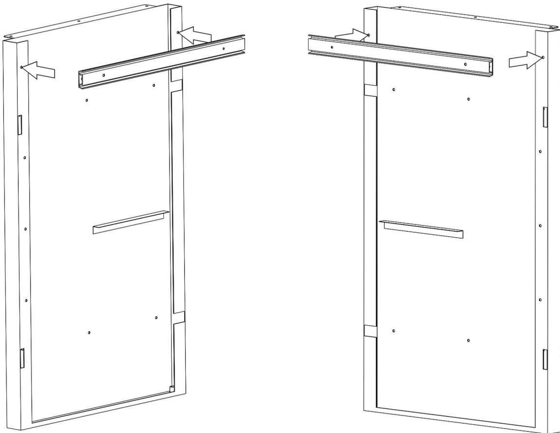
Schrauben Sie mit Hilfe von vier Schraubensets (19) jeweils eine Schubladenführung (13) an die Seitenwand 1 (1) und Seitenwand 2 (2).
