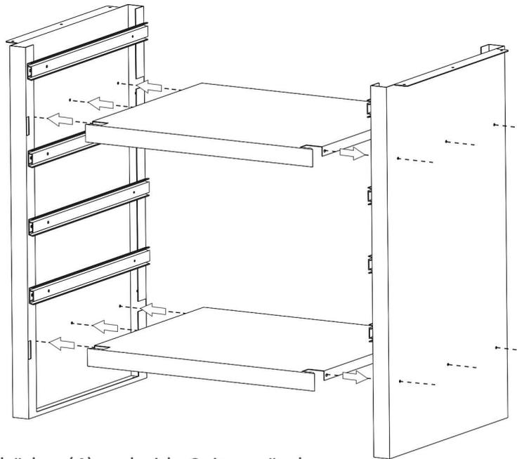
Schrauben Sie die Fachböden (4) an beide Seitenwände.
