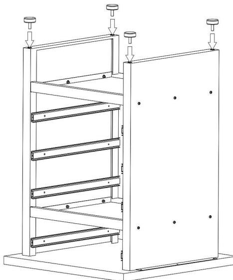
Schrauben Sie die vier Justierfüße (12) in die Seitenwände der Werkbank.
