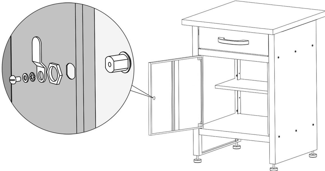
Stecken Sie den Schließzylinder des Schlosses (17) durch die in der Tür vorgesehene Öffnung und fixieren Sie ihn wie in der Abbildung. Prüfen Sie vorher, ob die Schließrichtung korrekt ist.
