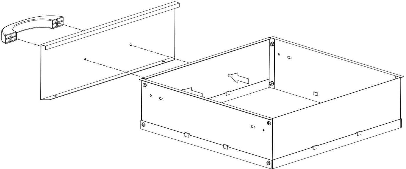
Schrauben Sie die Schubladenblende (8) und den Schubladengriff (14) mit Hilfe von zwei Schneidschrauben (21) wie abgebildet an die Schubladenfront.
