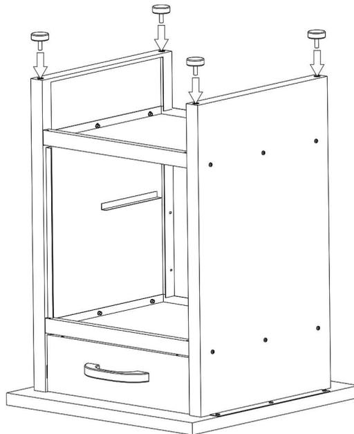
Schrauben Sie die vier Justierfüße (15) in die Seitenwände der Werkbank.
