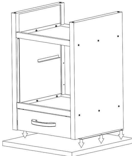
Kippen Sie die Werkbank nach hinten, um diese auf die Arbeitsplatte (18) zu setzen. Schrauben Sie mit Hilfe von sechs Schneidschrauben (21) die Konstruktion auf die Markierungen der Unterseite der Arbeitsplatte.
