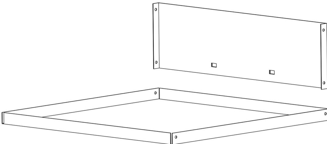
Setzen Sie die Schubladenrückwand (7) auf die Rückseite des Schubladenbodens (9). Schrauben Sie die beiden Teile noch nicht zusammen! Achten Sie beim Verschrauben der Einzelteile darauf, dass die Schraubenköpfe außen sitzen und die Muttern sowie Unterlegscheiben innen sitzen.
