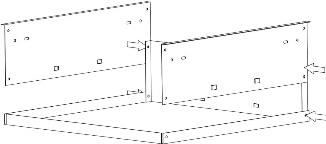
Schrauben Sie jetzt beide Schubladenseitenwände (8), die Schubladenrückwand sowie den Schubladenboden zusammen.
