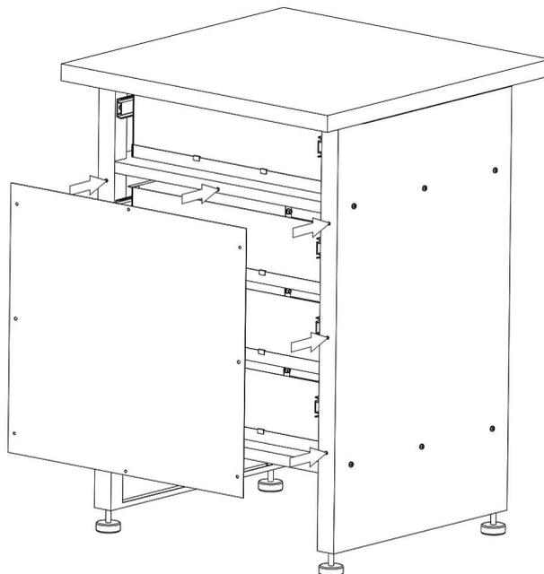
Schrauben Sie die Rückwand (3) an die Konstruktion.
