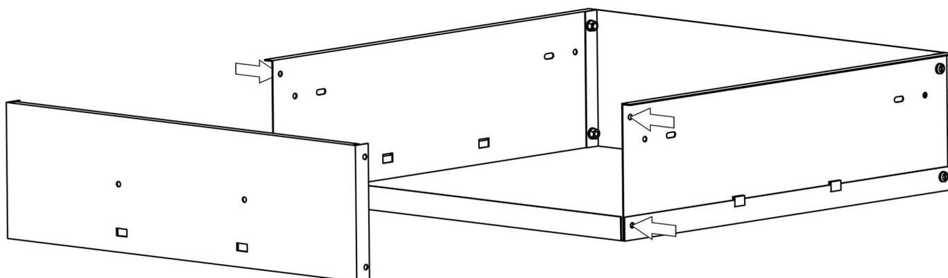
Schrauben Sie die Schubladenfront (9) an die Schubladenseitenwände.
