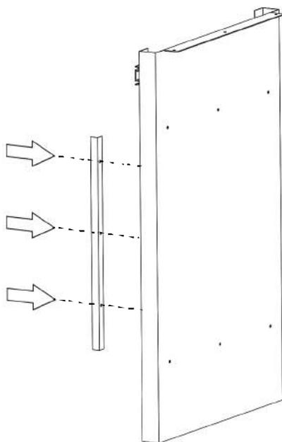
Schrauben Sie jetzt den Türanschlag (6) an die Seitenwand 2 (2).
