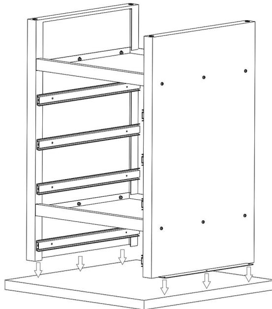
Kippen Sie die Werkbank nach hinten, um diese auf die Arbeitsplatte (14) zu setzen. Schrauben Sie mit Hilfe von sechs Schneidschrauben (17) die Konstruktion auf die Markierungen der Unterseite der Arbeitsplatte.
