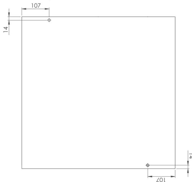
Markieren Sie die benötigten Befestigungspunkte auf der Unterseite der Arbeitsplatte (14).
