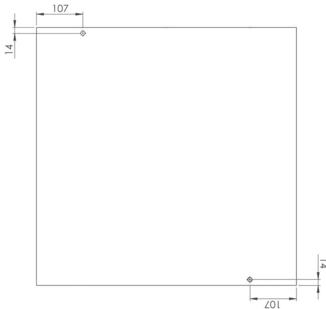
Markieren Sie die benötigten Befestigungspunkte auf der Unterseite der Arbeitsplatte (18).
