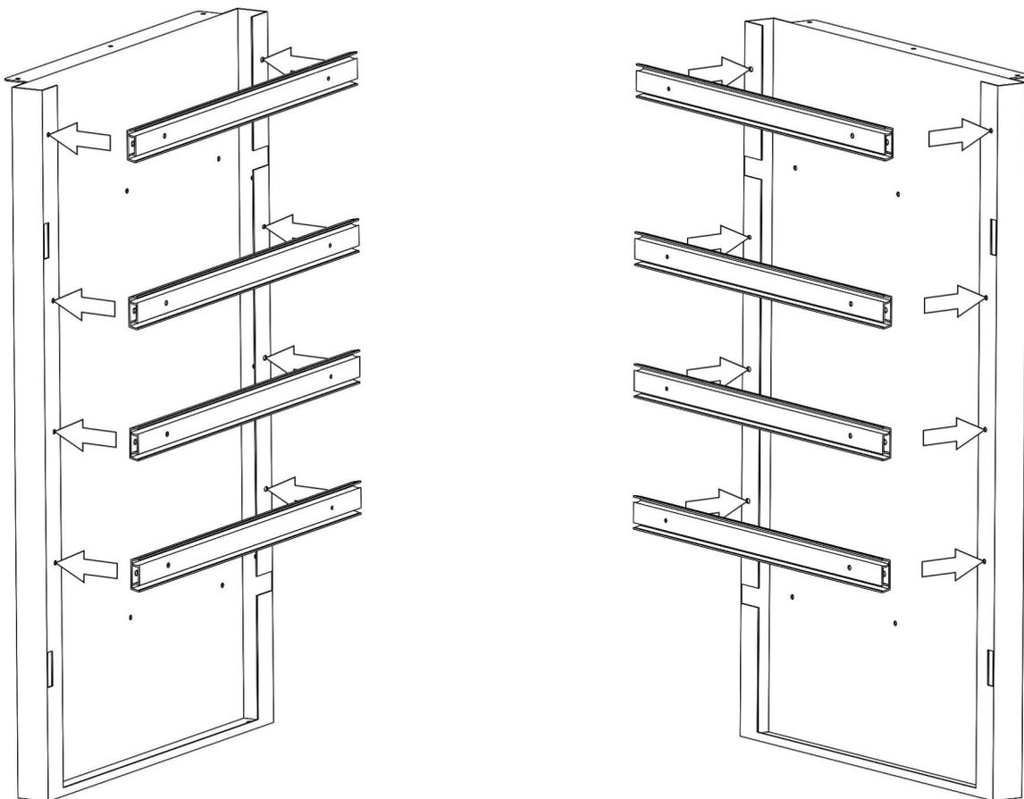
Schrauben Sie mit Hilfe von sechzehn Schraubensets (15) jeweils eine Schubladenführung (10) an die Seitenwand 1 (1) und Seitenwand 2 (2).
