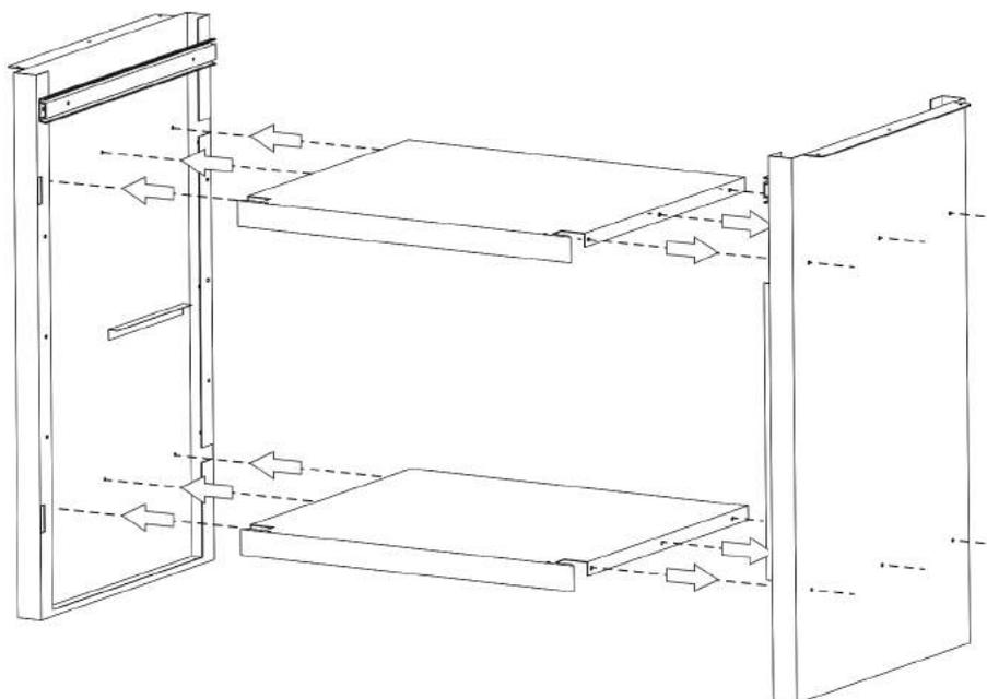
Schrauben Sie die Fachböden (4) an beide Seitenwände.
