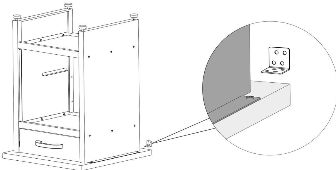
Schrauben Sie die beiden Anbauwinkel (16) mit Hilfe von jeweils vier Schneidschrauben (21) an den Ecken auf der Rückseite der Arbeitsplatte. Stellen Sie die Werkbank wieder auf.
