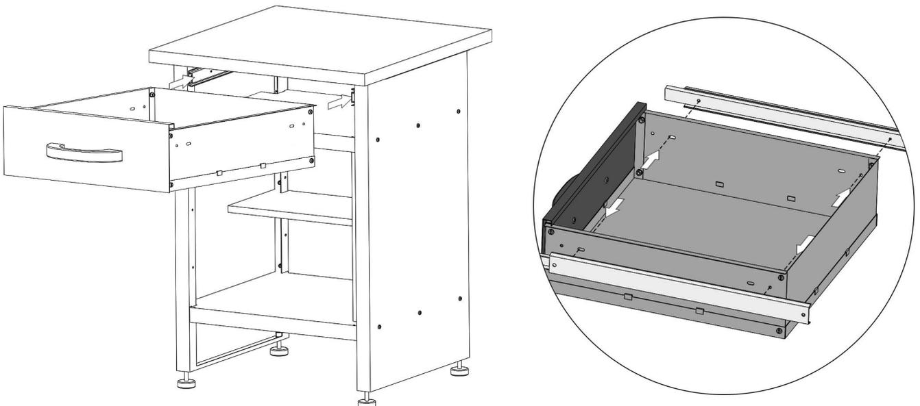
Ziehen Sie die Schubladenführungen heraus und schrauben Sie die Schublade an die Schubladenführungen.
