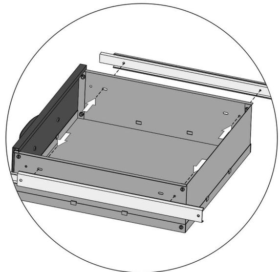
Ziehen Sie die Schubladenführungen heraus und schrauben Sie die Schubladen an die Schubladenführungen.
