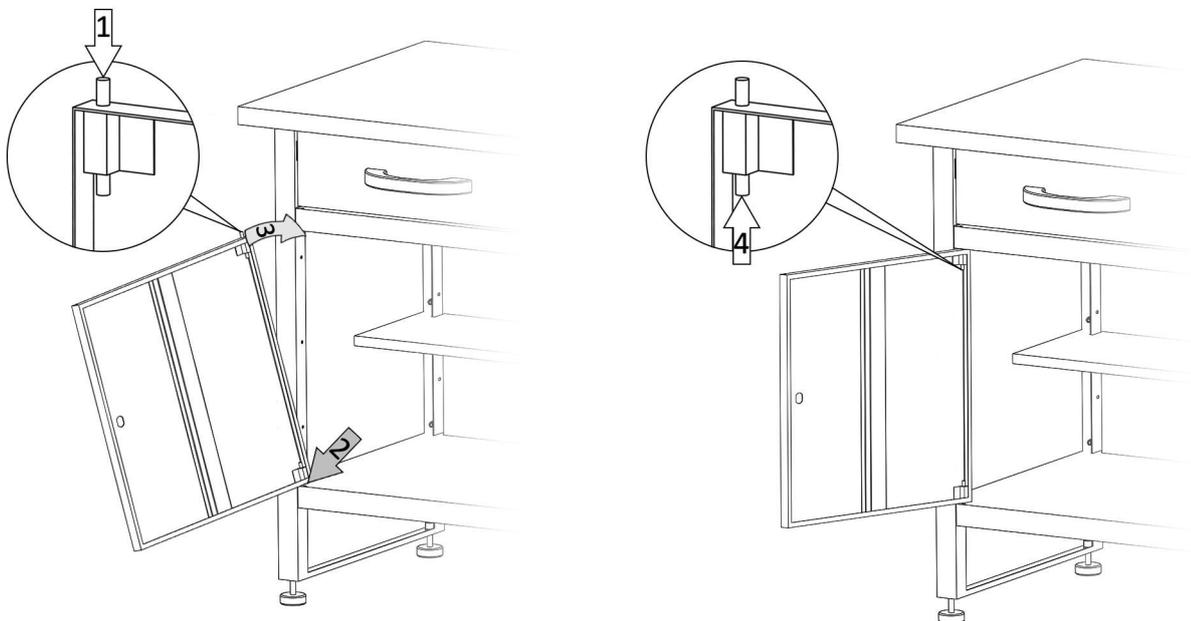
Drücken Sie den oberen Splint des Türscharniers nach unten und montieren sie die Tür (5) wie in der Abbildung beschrieben an den Korpus. Um die Tür zu fixieren, drücken Sie den oberen Splint wieder in die vorgesehene Öffnung im Rahmen. Zum Bewegen der Splinte sind gegebenenfalls seichte Schläge mit dem Hammer nötig.
