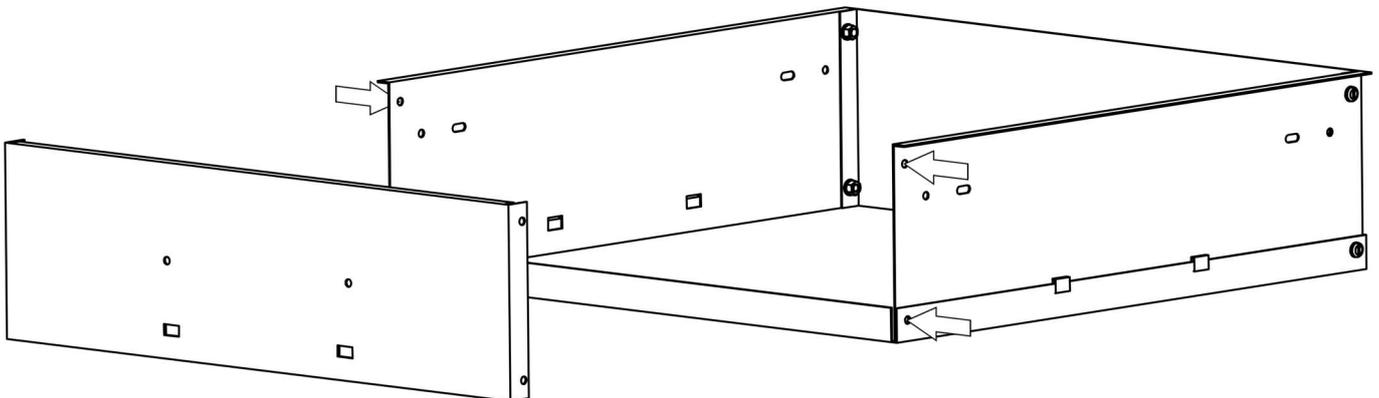
Schrauben Sie die Schubladenfront (6) an die Schubladenseitenwände.
