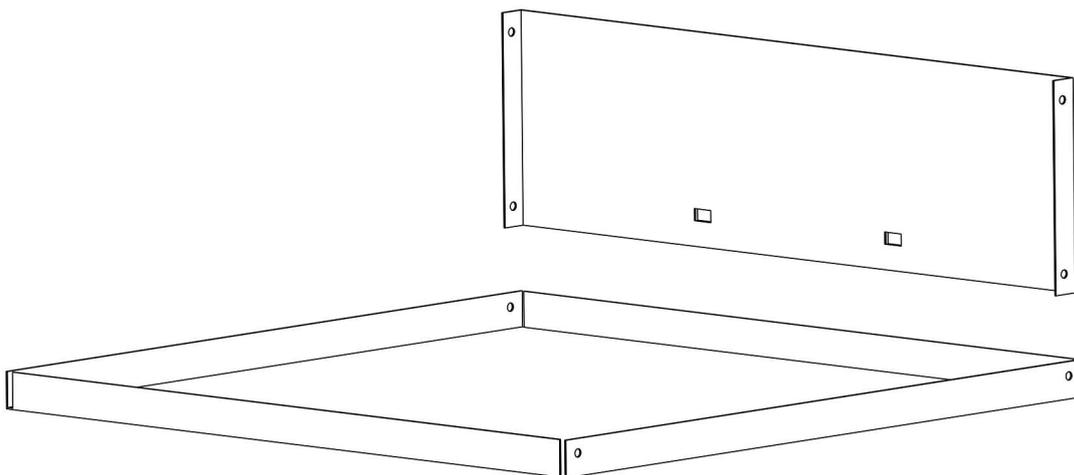
Setzen Sie die Schubladenrückwand (10) auf die Rückseite des Schubladenbodens (12). Schrauben Sie die beiden Teile noch nicht zusammen! Achten Sie beim Verschrauben der Einzelteile darauf, dass die Schraubenköpfe außen sitzen und die Muttern sowie Unterlegscheiben innen sitzen.
