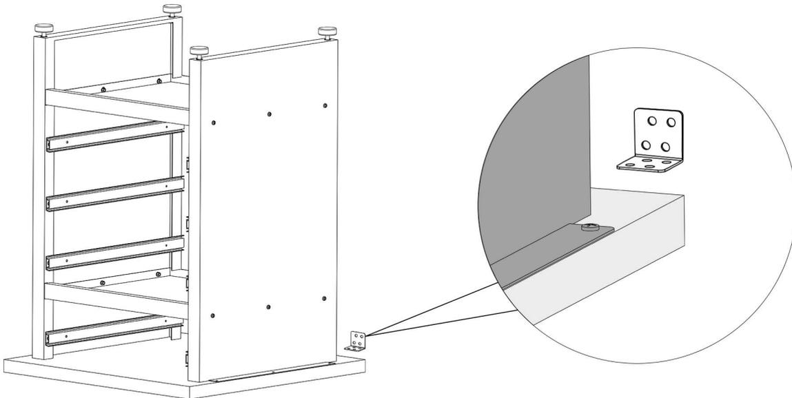
Schrauben Sie den Anbauwinkel (13) mit Hilfe von vier Schneidschrauben (17) an die Ecke auf der Rückseite der Arbeitsplatte. Stellen Sie die Werkbank wieder auf.
