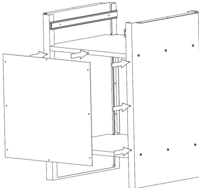
Schrauben Sie die Rückwand (3) an die Konstruktion.
