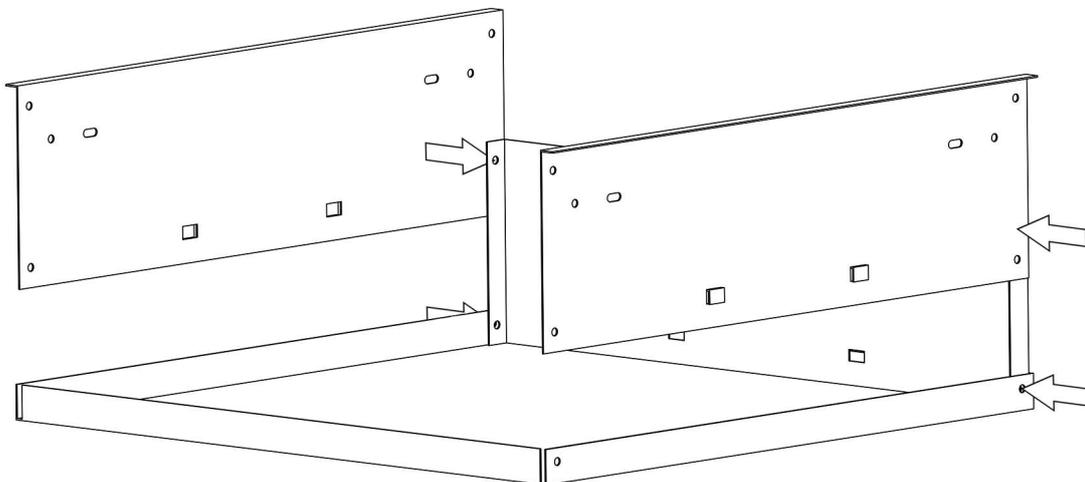
Schrauben Sie jetzt beide Schubladenseitenwände (11), die Schubladenrückwand sowie den Schubladenboden zusammen.
