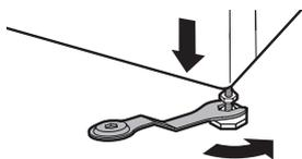
2 Überprüfen Sie mit einer Wasserwaage ❶, ob das Gerät komplett waagrecht steht.
