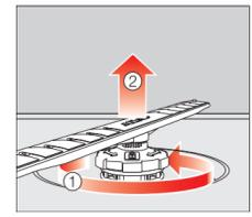
■ Drehen Sie die Verschraubung des unteren Sprüharms gegen den Uhrzeigersinn ① und ziehen Sie den Sprüharm nach oben ab ②.
