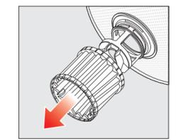
■ Zum Reinigen der Siebinnenseite ziehen Sie den Mikrofilter an dem Kunststoffring nach unten von der Siebkombination ab.
