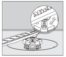
■ Drehen Sie die Verschraubung des unteren Sprüharms im Uhrzeigersinn, bis der Pfeil im Sichtfenster auf das Schlosssymbol zeigt.
