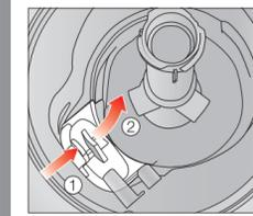
■ Drücken Sie die Verriegelung der Abdeckung der Ablaufpumpe nach innen ①.
