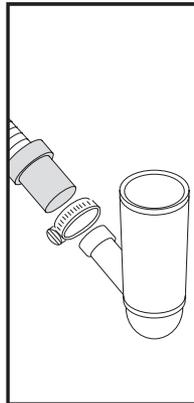
Der Ablaufschlauch kann auch mit einem Anschlussnippel in der Wasserleitung des Ablaufes verbunden werden. Der Anschlussnippel muss einen Innendurchmesser von mindestens 14 mm haben.
