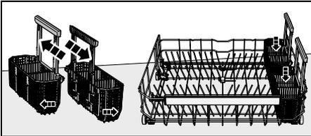
Der Besteckkorb kann in zwei Teile zerlegt werden, die sich dann am unteren Korb seitlich befestigen lassen.
