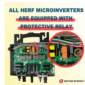
Dies wurde sicherheitshalber an einigen im SUNSET-Lager vorrätigen Wechselrichtern überprüft. Da die Wechselrichter innen vollständig eingegossen sind, wurde die Stelle des orangen mechanischen Kuppelschalters freigelegt (siehe Foto).
