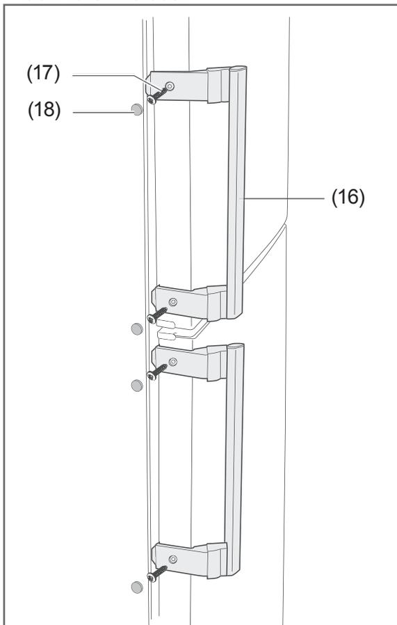
2. Befestigen Sie die Türgriffe (16) mit den beiliegenden Schrauben (17) an beiden Türen.
