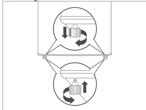
3. Gleichen Sie Unebenheiten des Untergrunds mithilfe der beiden vorderen Schraubfüße aus.
