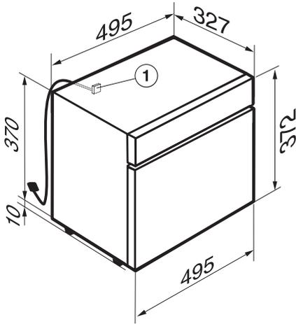
① Netzanschlussleitung – Einführung am Dampfgerar
