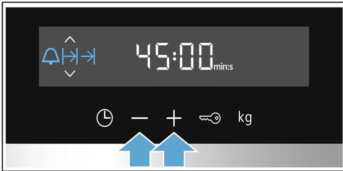
Nach wenigen Sekunden beginnt das Gerät zu heizen. Im Display läuft die Dauer ab.
