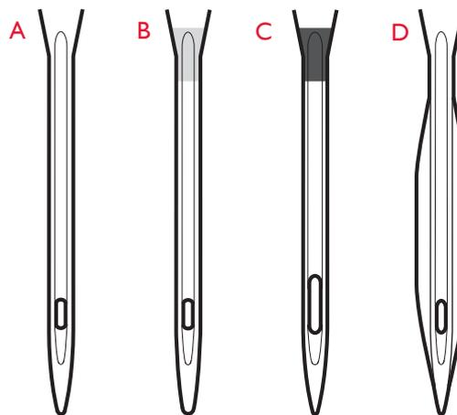
*Hinweis: Die Nadel häufig wechseln. Immer mit einer geraden und spitzen Nadel (1) arbeiten. Eine beschädigte Nadel (2) kann zu ausgelassenen Stichen, Nadelbruch oder Fadenreißen führen. Eine beschädigte Nadel kann auch die Stichplatte beschädigen.*
