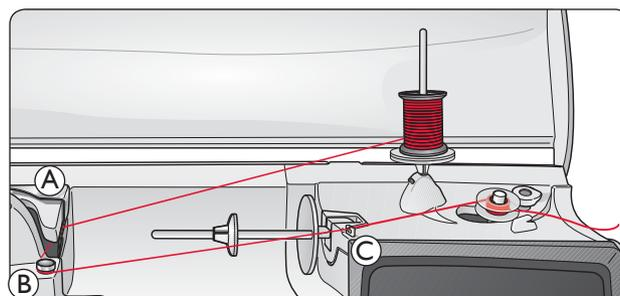
*Hinweis: Abhängig vom Garntyp den Faden ein- oder zweimal um die Fadenspannungsscheibe (B) wickeln, um die Fadenspannung zu erhöhen.*
