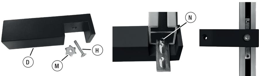
**Achtung:** Verbinden Sie zuerst beide Profile mit dem Profilverbinder und setzen Sie erst danach den Träger in das mittlere Loch des Profilverbinders ein.
