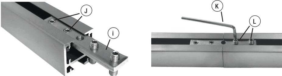
Möchten Sie einen Träger (siehe Schritt 2) genau bei der Profilstückelung setzen, kann der Nutstein **M** sowie die Schraube **H** vom Träger **D** abgenommen werden (Nutstein und Schraube werden nicht mehr benötigt). Nun nehmen Sie die Schraube **N** welche lose beim Profilverbinder beige packt ist und verwenden Sie diese anstatt der Schraube **H**. Drehen Sie diese in das mittlere Loch des Profilverbinders **i**.
