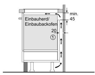
① Lüftungsspalt muß vorgesehen werden. Maße in mm
