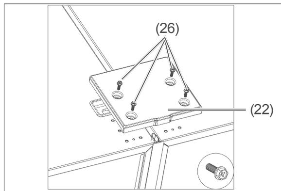
8. Schrauben Sie die obere Abdeckung (22) mit den 4 übrigen Schrauben (26) fest.
