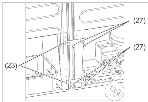
2. Verbinden Sie die beiden Geräte zunächst mittels zwei der Verbindungsstücke (23) und vier der Schrauben (27).
