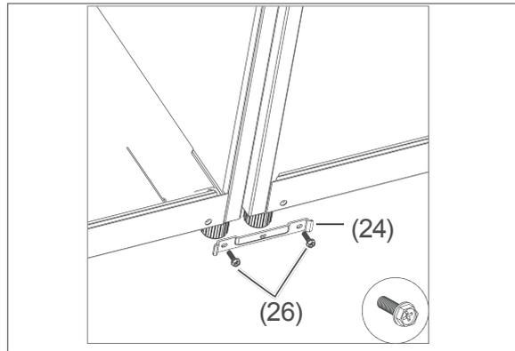
6. Verbinden Sie die Geräte an der Vorderseite mit dem Verbindungsstück Gerätevorderseite (24) und 2 der Schrauben (26).
