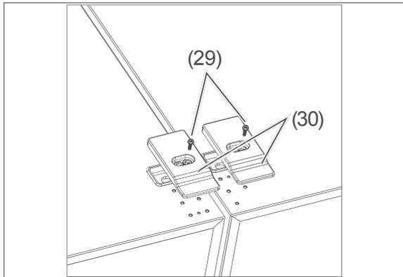
3. Lösen Sie nun die beiden Schrauben (29) der oberen Abdeckungen (30) der Einzelgeräte, und nehmen Sie diese ab.
