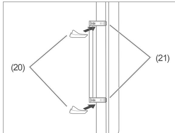
3. Schieben Sie die beiliegenden Zierblenden (20) über die Griffgehäuse (21).
