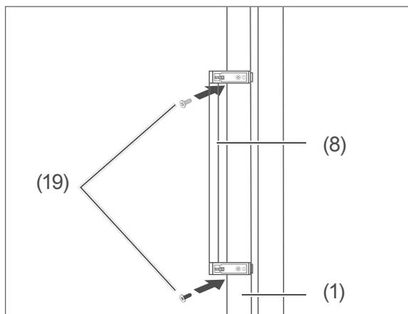
2. Schrauben Sie den Türgriff (8) mit den beiliegenden Schrauben (19) an die Gerätetür (1).
