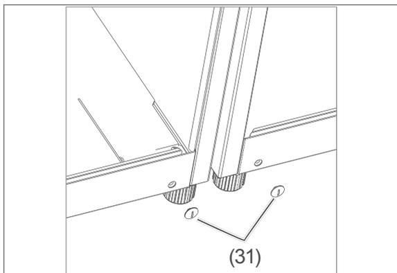
5. Hebeln Sie mithilfe eines Bindfadens oder eines kleinen Schraubendrehers die Blindstopfen (31) an den Vorderseiten der Geräte heraus.
