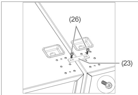
4. Verbinden Sie die beiden Geräte mittels des dritten Verbindungsstücks (23) sowie 2 der Schrauben (26).
