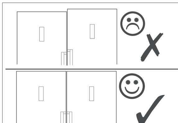
1. Stellen Sie die beiden Geräte nebeneinander auf, und richten Sie sie mithilfe der jeweiligen Schraubfüße so aus, dass sie sich auf einer Höhe befinden.
