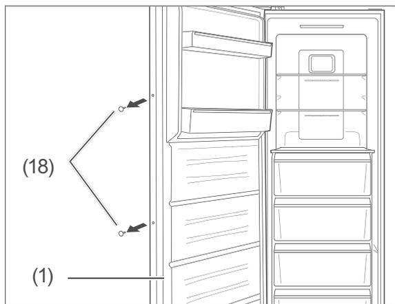
1. Hebeln Sie die beiden Blindstopfen (18) aus der Seite der Gerätetür (1).
