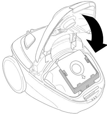
7. Verschließen Sie wieder das Staubbeutel Fach. Achten Sie dabei darauf, dass der Staubbeutel nirgends eingeklemmt wird.
