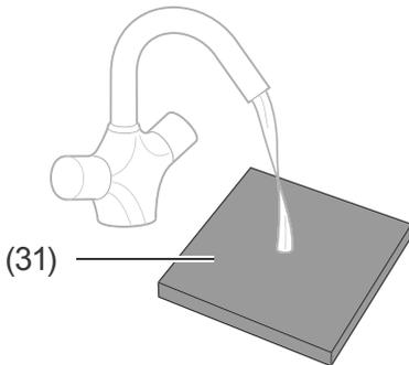
5. Waschen Sie den Motorschutz-Filter unter fließendem Wasser aus.
