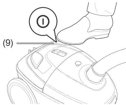
3. Treten Sie mit dem Fuß auf den Fußschalter Ein/Aus (9), um das Gerät einzuschalten.
