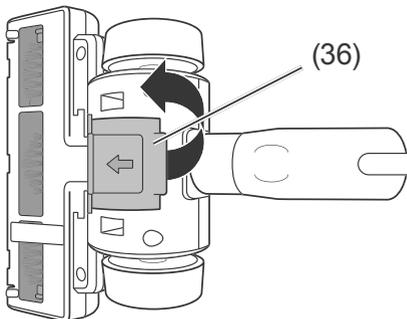
2. Öffnen Sie die Wartungsklappe (36) auf der Unterseite der Turbodüse.
