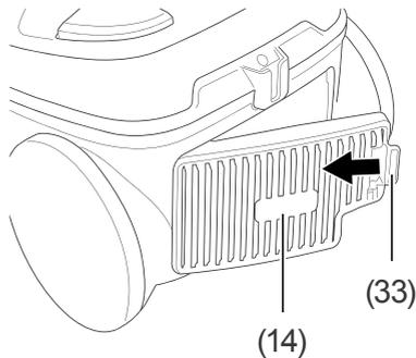
2. Drücken Sie den Verschluss (33) nach links und nehmen Sie die Filterabdeckung ab.
