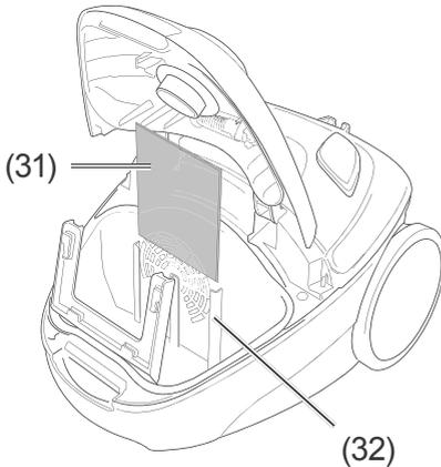
4. Ziehen Sie den Motorschutz-Filter (31) aus der Halterung (32) nach oben heraus.
