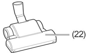
Die rotierende Turbodüse (22) wird durch den Saug-Luftstrom angetrieben. Sie eignet sich besonders für Verschmutzungen wie z. B. Haare und Fäden auf Teppichen und Teppichböden. Stellen Sie beim Einsatz der Turbodüse den Staubsauger auf maximale Saugleistung (siehe Abschnitt „Saugkraft einstellen“ auf Seite 17).
