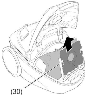
3. Ziehen Sie den Staubbeutel an der Papplasche nach oben aus dem Staubbeutelhalter (30) heraus.
