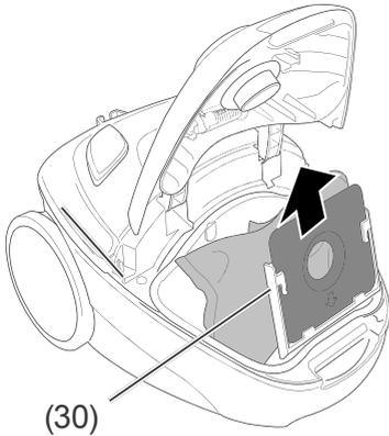
3. Ziehen Sie den Staubbeutel an der Pappflasche nach oben aus dem Staubbeutelhalter (30) heraus. Der Staubbeutelhalter klappt dabei in eine senkrechte Position.
