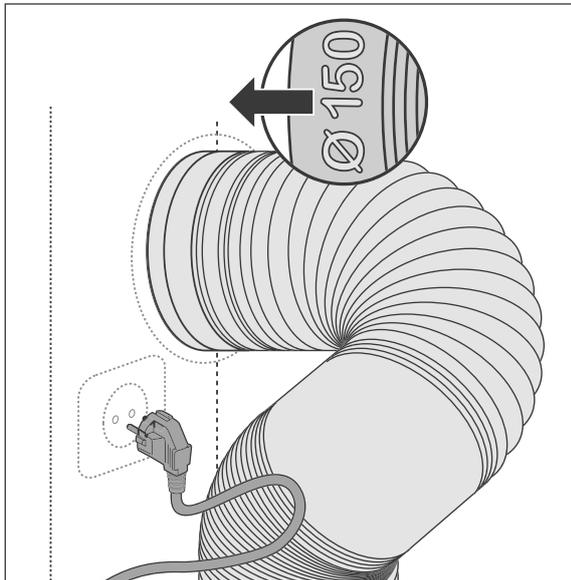
5. Stecken Sie den Abluftschlauch mit der 150 mm durchmessenden Öffnung auf den Anschluss in/an der Wand/Decke.
