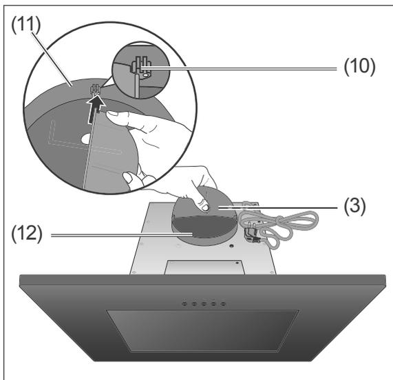
1. Stecken Sie die beiden Flügel der Rückschlagklappe (3) mit den Pins (10) in die Aufnahmelöcher (11) an der Abluftöffnung (12).
