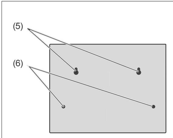
1. Drehen Sie 2 Befestigungsschrauben in die oberen Schraubdübel, so dass beide Schrauben noch etwa 1 cm herausragen.
