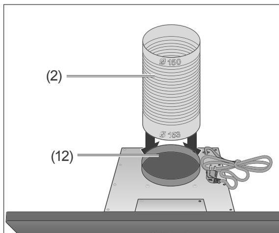
3. Stecken Sie den Abluftschlauch (2) mit der 153 mm durchmessenden Öffnung auf die Abluftöffnung (12).
