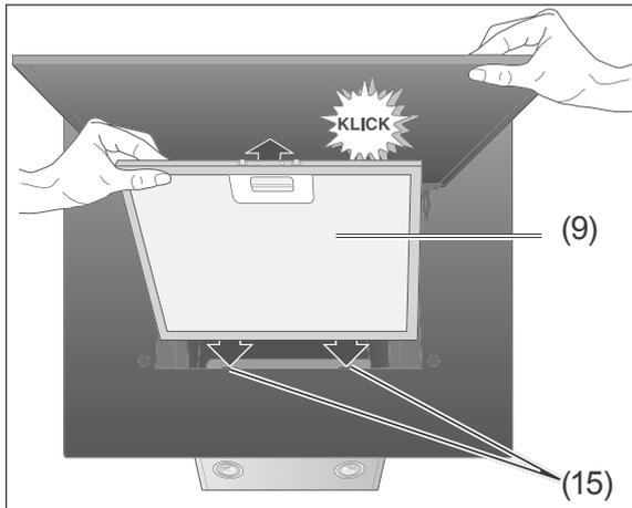
5. Wenn der Fettfilter vollständig getrocknet ist, setzen Sie ihn mit den Zapfen in die Aussparungen (15).
