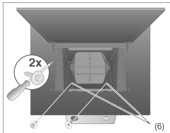
6. Drehen Sie zwei Befestigungsschrauben zum Sichern der Dunstabzugshaube durch die Sicherungs-Öffnung (6) in die vorbereiteten Dübel und schrauben Sie die Dunstabzugshaube an der Wand fest.
