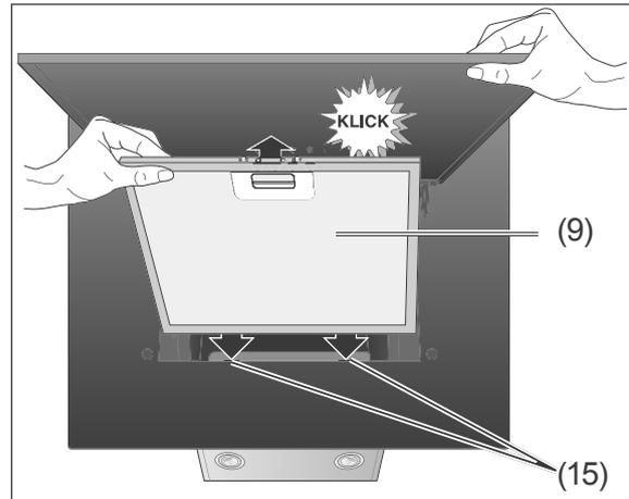
6. Setzen Sie den Fettfilter (9) mit den Zapfen in die Aussparungen (15).
