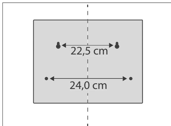
3. Um die seitlichen Abstände einzuhalten, zeichnen Sie die vier Bohrlöcher gemäß obigen Schemas auf der Wand an.
