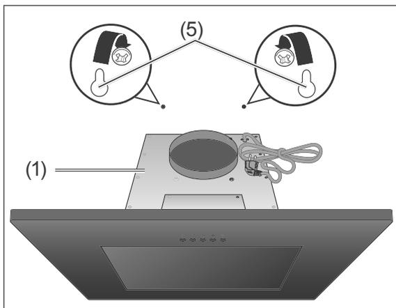
3. Nehmen Sie die Dunstabzugshaube gegebenenfalls wieder ab und drehen Sie die Schrauben weiter hinein- oder heraus, bis eine gute Verbindung mit der Wand besteht.
