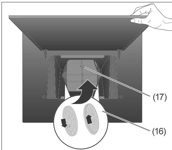
5. Setzen Sie die neuen Kohlefilter rechts und links auf den Motor und drehen Sie sie gegen den Uhrzeigersinn fest. Dabei die Verriegelung einrasten lassen.
