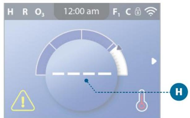
Wenn der Entlüftungsmodus (automatisch oder manuell) endet, erscheinen im Bedienfeld Striche (H). Sobald die Steuerung das Wasser eine Minute lang durch die Heizung strömen lässt, werden die Striche durch die Wassertemperatur ersetzt.
