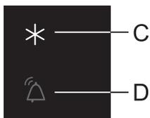
Schalten Sie die Funktion Intensivkühlen ein, indem Sie die Taste **A** so oft drücken, bis der Buchstabe **C** aufleuchtet.
