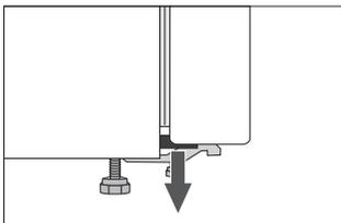
An den Ecken der Gerätedür sind Distanzhalter angebracht, die Sie entfernen und durch die mitgelieferten Stöpsel (nur bei einigen Modellen) ersetzen.
