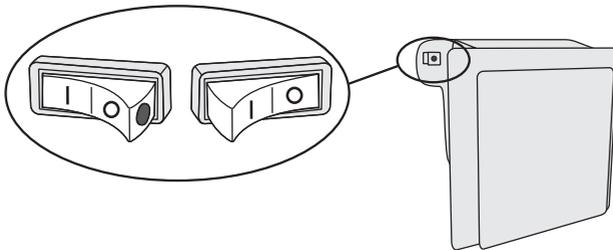
Wenn der Ionisator eingeschaltet ist, ist auf dem Schalter ein roter Punkt sichtbar.
