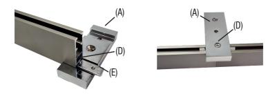
Achtung: Verbinden Sie zuerst beide Profile mit dem Profilverbinder und setzen Sie erst danach den Träger in das mittlere Loch des Profilverbinders ein.
