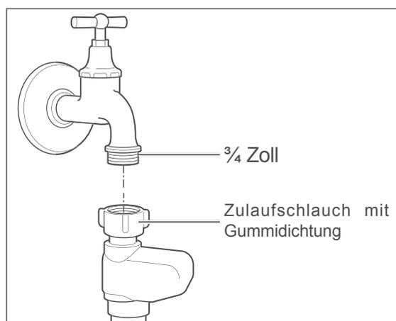
Für die Wasserversorgung benötigen Sie einen Wasserhahn mit einem  $\frac{3}{4}$  Zoll Schraubanschluss.
