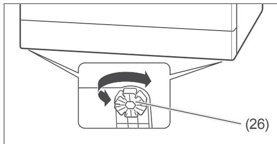
5. Um Unebenheiten des Bodens auszugleichen und den Geschirrspüler waagrecht auszurichten, können Sie die vier Gerätefüße (26) heraus- oder hineindreihen. In den Gerätefüßen sind ringsherum Schlitze angebracht. Stecken Sie hier einen Schraubendreher hinein und drehen Sie damit den Gerätefuß. Verwenden Sie zum Ausrichten des Geschirrspülers eine Wasserwaage.
