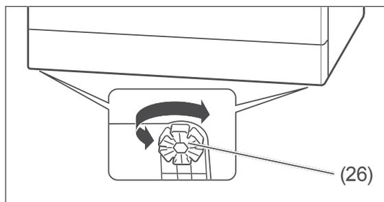
3. Um Unebenheiten des Bodens auszugleichen und den Geschirrspüler waagrecht auszurichten, können Sie die vier Gerätefüße (26) heraus- oder hineindrehen. In den Gerätefüßen sind ringsherum Schlitze angebracht. Stecken Sie hier einen Schraubendreher hinein und drehen Sie damit den Gerätefuß. Verwenden Sie zum Ausrichten des Geschirrspülers eine Wasserwaage.
