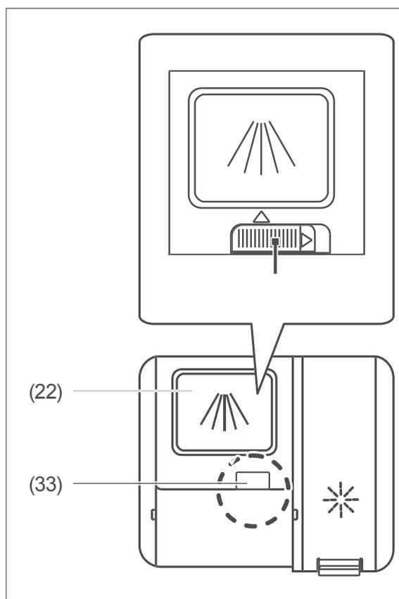
1. Schieben Sie den Verschluss (33) der Spülmittelekammer (22) zur Seite. Der Deckel springt auf.
