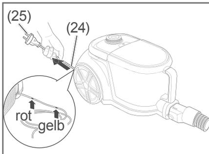
1. Ziehen Sie das Netzkabel (24) am Netzstecker (25) heraus, bis die gelbe Markierung auf dem Netzkabel (24) sichtbar wird.
