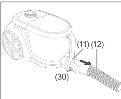
2. Ziehen Sie den Saugschlauch (12) von der Öffnung (11) der Saugschlauchverbindung ab. Drücken Sie
