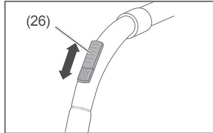
Bei Bedarf können Sie die Saugkraft mithilfe des Nebenluftventils (26) weiter verringern. Die Abdeckung des Nebenluftventils (26) lässt sich stufenlos verschieben.
