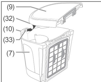
6. Setzen Sie den Staubbehälterdeckel (9) wieder auf den Staubbehälter. Achten Sie dabei darauf, dass die Halterung (32) am Staubbehälterdeckel (9) in die Aussparung (33) am Tragegriff (10) des Staubbehälters (7) eingreift.
