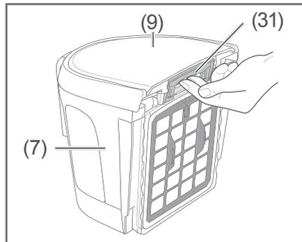
4. Lösen Sie die Arretierung (31) unter dem Staubbehälterdeckel (9), und nehmen Sie den Staubbehälter (7) ab.
