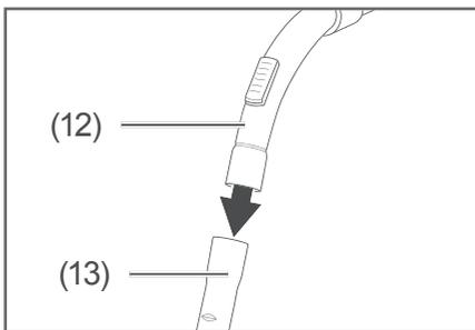
1. Stecken Sie den Saugschlauch (12) und das Teleskoprohr (13) zusammen.
