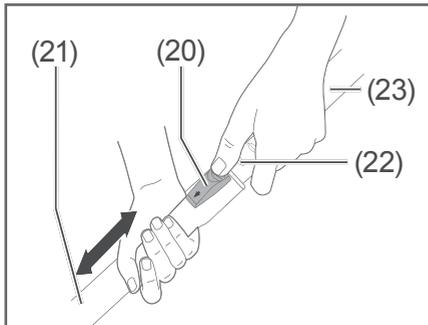
4. Die Länge des Teleskoprohrs (13) lässt sich verändern und dadurch an die Körpergröße des Benutzers anpassen. Halten Sie dazu den oberen Teil (23) des Teleskoprohrs (13) mit einer Hand fest, und drücken Sie die Arretierung (20) nach unten. Schieben Sie dabei gleichzeitig mit der andern Hand den unteren Teil (21) des Teleskoprohrs (13) von sich weg oder auf sich zu.
