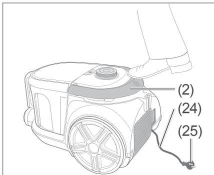
3. Treten Sie zum Aufwickeln des Netzkabels (24) auf den Fußschalter (2) für die Kabelaufwicklung. Halten Sie dabei das Netzkabel (24) am Netzstecker (25) in der Hand, um einen eventuellen „Peitscheneffekt“ zu verhindern.
