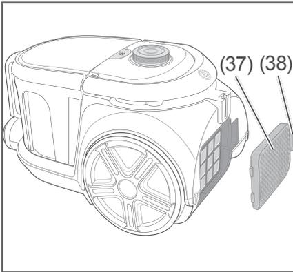
2. Nehmen Sie die Filterabdeckung (37) ab. Drücken Sie dazu die Entriegelungstaste (38).
