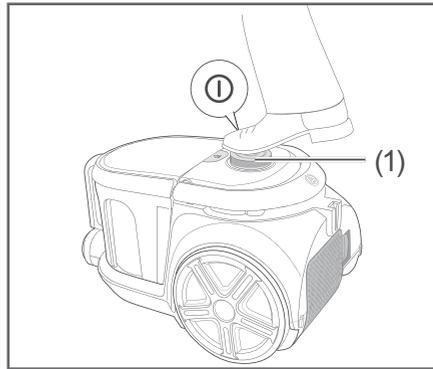
3. Treten Sie mit dem Fuß auf den Fußschalter Ein/Aus (1), um das Gerät einzuschalten.
