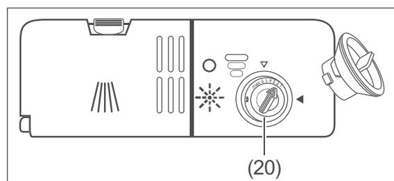
1. Drehen Sie den Deckel der Klarspülmittekkammer (20) eine Viertelumdrehung gegen den Uhrzeigersinn und nehmen Sie ihn heraus.
