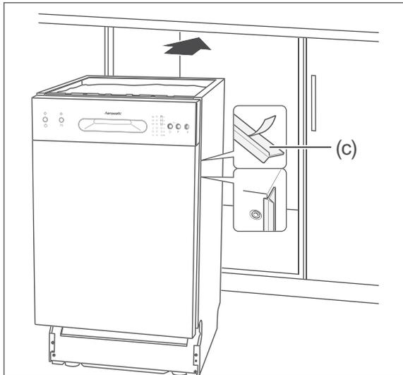
3. Entfernen Sie die Schutzfolien von den seitlichen Abschlussprofilen (c).
