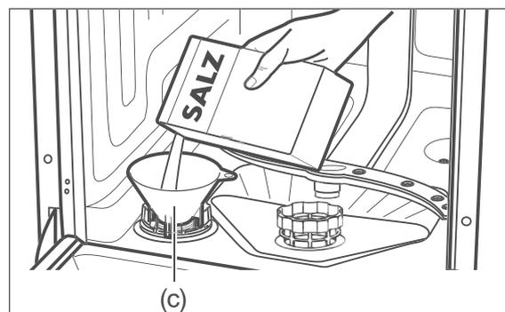
4. Setzen Sie den mitgelieferten Einfülltrichter (c) auf die Kammeröffnung.
