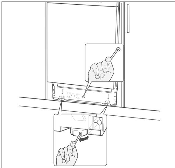
6. Um den Geschirrspüler waagrecht auszurichten, sind die beiden vorderen Gerätefüße und der hintere Gerätefuß höhenverstellbar. Die vorderen Gerätefüße sind mit Schlitz versehen. Stecken Sie einen
