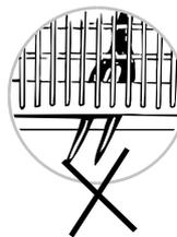
Achten Sie beim Einladen des Bestecks darauf, dass es nicht durch den Boden des Besteckkorbs stößt. Der untere Sprüharm wird sonst blockiert.
