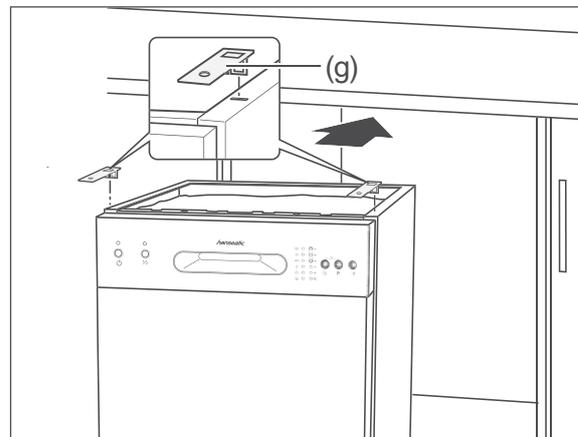
2. Stecken Sie beide Montagewinkel (g) in die vorderen Schlitze an der oberen Seite des Geschirrspülers, um später den Geschirrspüler an die Arbeitsplatte anschrauben zu können.
