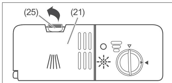
1. Ziehen Sie den Verschluss (25) der Spülmittelkammer (21) nach hinten. Der Deckel springt auf.
