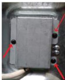
Nach der Installation des Stromkabels, schrauben Sie die Metallabdeckung mit drei Schrauben fest.
