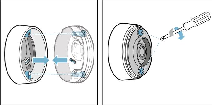
4. Die Siliconabdeckung wieder am Gehäuseunterteil des Temperatursensors anbringen.
