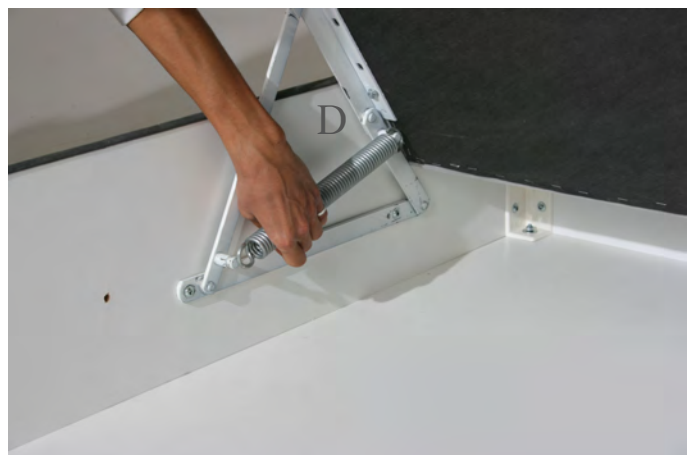
e) Federn auf beiden Seiten einhängen
