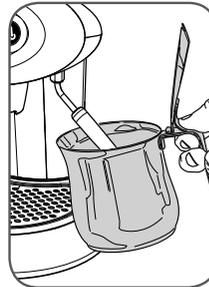
Colocar um recipiente metálico em baixo do bico de fornecimento de vapor.
