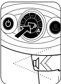
Encender la máquina: dentro de 15 segundos tras el encendido, pulsar y mantener pulsado el botón
