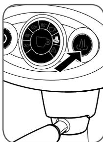
Tryk på knappen for damp
