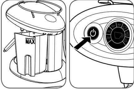
Tænd maskinen ved at holde hovedkontakten
