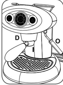
تنبيه: بينما الجهاز قيد التشغيل، قد يؤدي تلامس رأس التحضير D أو أنبوب البخار O أو الجزء المعدني الخاص بحامل الكبسولات إلى الحرق.
