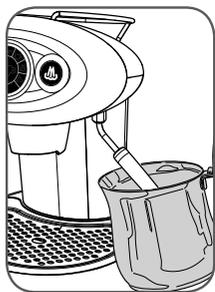
将合适的空容器（最好是金属壶）放在蒸汽冲泡管下，然后按
