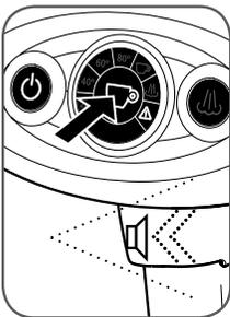
Zet de machine aan: druk binnen 15 seconden na het aanzetten op de knop
