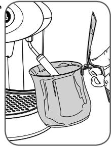
اضغط على الزر "MAX" مرة واحدة لبدء دورة إزالة الترسبات. يومض الزران "MAX" و"MAX" بشكل متبادل. يتم صب الماء بشكل متقطع من رأس تحضير القهوة وأنبوب البخار (المدة: ١٤ دقيقة).
