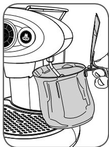
将蒸汽冲泡管完全浸入牛奶中。
