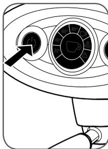
关闭本机并从电源插座上拔下插头。
