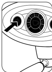
要关闭本机，请按住
