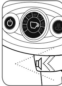
Et langt lydsignal angiver, at afkalkningsfasen er afsluttet. Herefter er det nødvendigt at fortsætte med fasen, hvor kredsløbene skylles for at fjerne eventuelle rester af afkalkningsopløsning.
