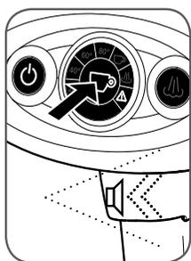
启动本机：在通电后 15 秒内，按住
