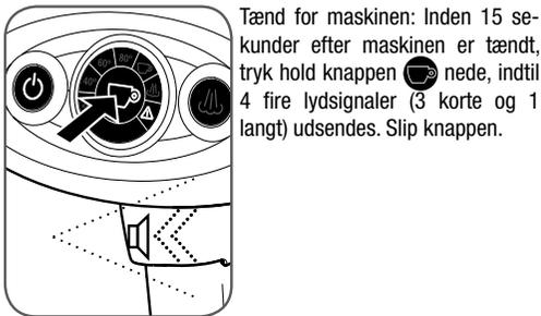
Tænd for maskinen: Inden 15 sekunder efter maskinen er tændt, tryk hold knappen
