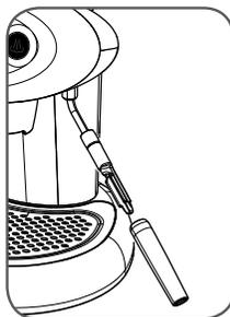
清除蒸汽冲泡管上的所有奶渣。
