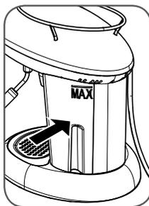
Instalar el depósito de la máquina controlando que quede correctamente fijado.
