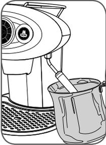
Colocar um recipiente adequado (de preferência metálico) vazio em baixo do bico de fornecimento de vapor e pressionar o botão para fazer sair a água residual; quando sair somente vapor, pressionar novamente o botão.
