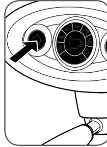
Para apagar la máquina, mantener presionado el botón
