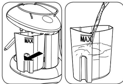
Снимите бак для воды, потянув его на себя. Наполните бак свежей питьевой водой до отметки MAX.
