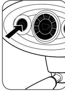
Для выключения машины удерживайте нажатой кнопку
