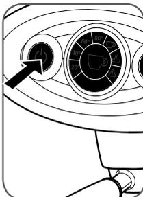
Sluk maskinen, og fjern stikket fra stikkontakten.
