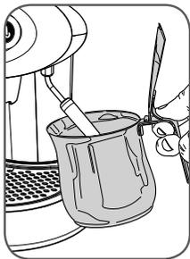
Поместите металлическую емкость под пароводводящую трубку.
