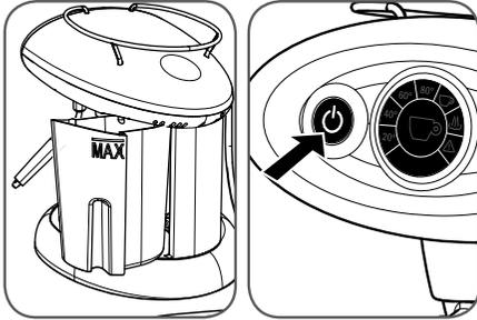
Druk op de knop
