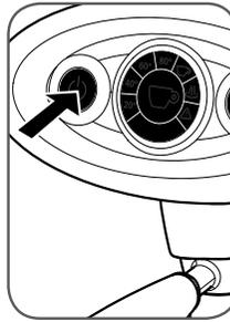
Houd de knop
