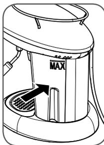
Sæt tanken på plads i maskinen. Kontrollér, at den er sat helt på plads.
