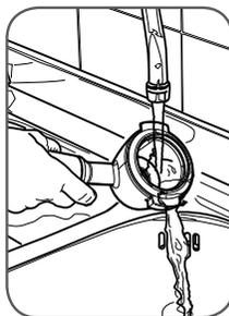
vaciar el portacápsulas y lavarlo con agua corriente;
