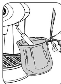
colocar un recipiente metálico debajo de la lanza vapor;
