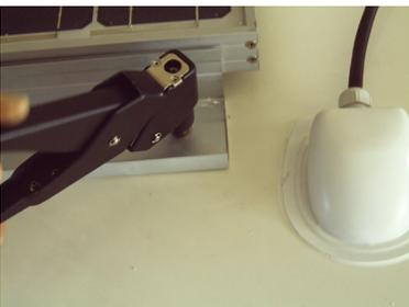
Als zusätzliche Befestigung können die Aluminiumschienen mit den mitgelieferten Nieten mit dem Fahrzeugdach verbunden werden. Dazu muss in Länge des Nietkopfes ein Loch in die Fahrzeugdachhaut gebohrt werden. Stecken Sie dann den Niet in die vorgesehene(n) Bohrung(en) und befestigen Sie diesen mittels Nietzange, an der Dachhaut.
