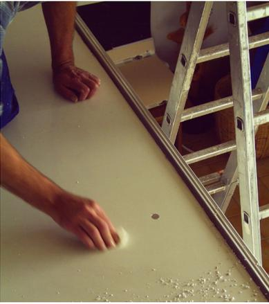
Nachdem Sie das Loch für die Dachdurchführung gebohrt haben, reinigen Sie gründlich die Fläche, auf der die Dachdurchführung aufgeklebt wird (siehe Abbildung links). Verwenden Sie dazu, z. B. Spiritus oder einen Spezialreiniger. Benutzen Sie zur Reinigung einen sauberen, fusselfreien Lappen. Verunreinigungen und Konservierungen, wie z. B. Wachs aus Waschstraßen, können die Haftbarkeit des Klebers beeinträchtigen.
