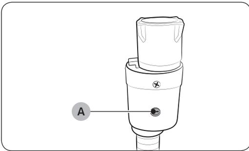
Der AquaStop-Schlauch warnt den Benutzer vor der Gefahr eines Wasseraustritts. Er misst den Wasserdurchfluss, und im Falle eines Lecks wechselt die **Anzeige (A)** in der Mitte des AquaSchlauchs ihre Farbe zu rot.
