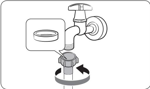
1. Verbinden Sie den Wasserschlauch mit dem Wasserhahn und drehen Sie den Überwurfring dann nach rechts fest.
