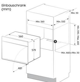
Der Einbauschrank muss über Lüftungsöffnungen (A) verfügen, um die Wärme abzuführen und die Luft zirkulieren zu lassen.
