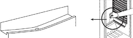
Veillez à ce que le canal et le trou d'écoulement ne soient pas bouchés afin que l'eau produite dans la chambre froide puisse toujours s'écouler librement.
