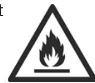
• Bij de verkoop, overdracht of bij recycling dient u het licht ontvlambare drijfgas Cyclo-pentaan ( $C_5H_{10}$ ) in de isolatie en het koelmiddel Isobutaan (R600a) te vermelden. Meer informatie over vakkundige recycling vindt u in het hoofdstuk *Verwijdering*.
