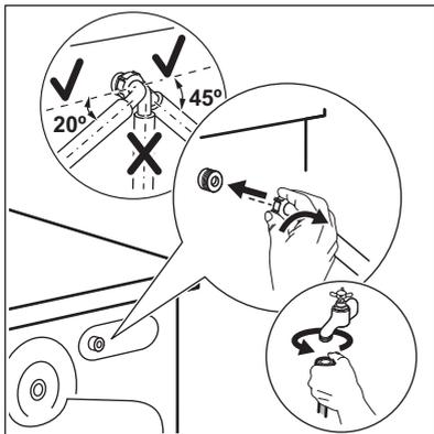
**i** Vergewissern Sie sich, dass sich der Zulaufschlauch nicht in der vertikalen Position befindet.
