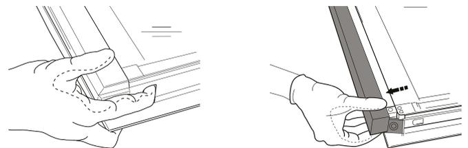
**2.** Das Innenglas mit beiden Händen anheben und fest halten, es entfernen und auf eine weiche Fläche legen, um es daraufhin zu reinigen.
