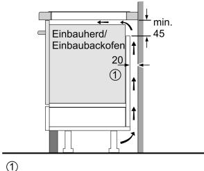
① Lüftungsspalt muß vorgesehen werden. min. 550 Maße in mm
