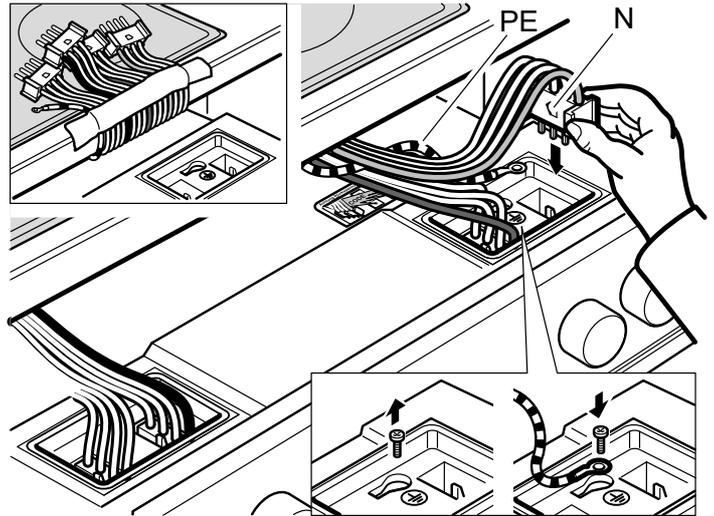
1. Herd soweit einsetzen, dass die Steckvorrichtung zugänglich ist.
