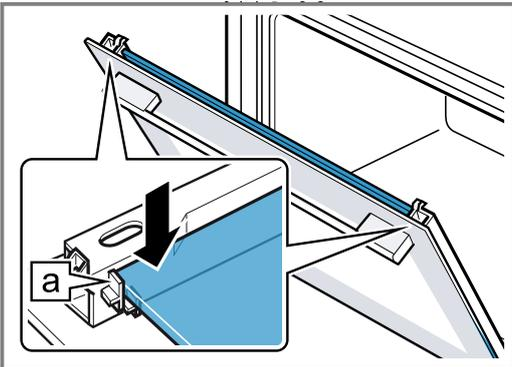
5. Die Gerätetür öffnen und Türdichtung einhängen.
