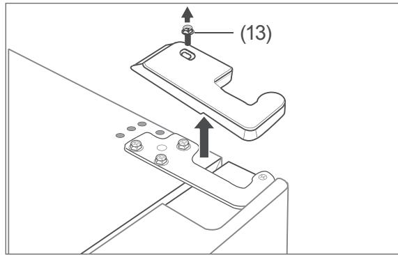
2. Schrauben Sie die Schraube (13) heraus. Nehmen Sie dann die Scharnierblende ab.
