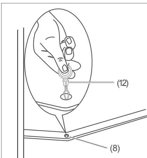
12. An der Rückwand des Kühlbereichs, oberhalb der Gemüseschublade befindet sich der Tauwasserablauf (8). Reinigen Sie ihn regelmäßig mit dem Reinigungswerkzeug (12).
