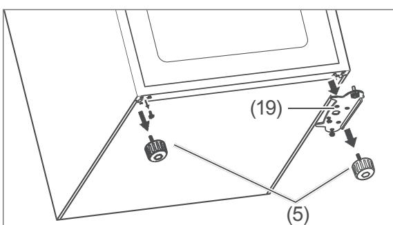
10. Kippen Sie das Gerät leicht nach hinten gegen eine Wand, sodass das untere Scharnier (19) zugänglich ist.
