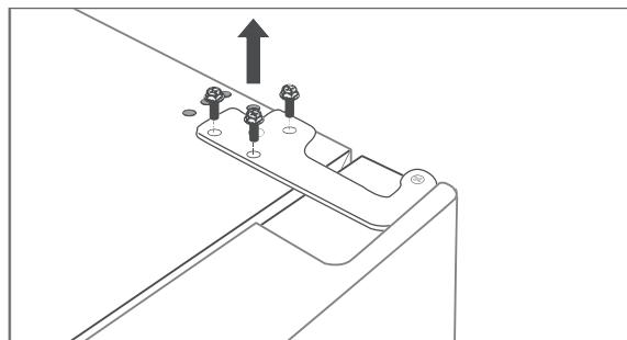
3. Schrauben Sie die 3 Schrauben am oberen Scharnier heraus und nehmen Sie das Scharnier ab.
