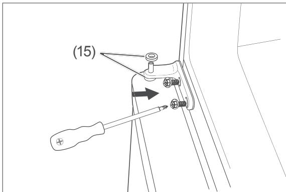
16. Setzen Sie das mittlere Scharnier wieder ein. Achten Sie dabei auf die beiden Kunststoffscheiben (15). Schrauben Sie das Scharnier fest.
