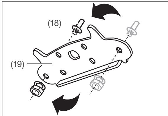
13. Versetzen sie den Scharnierbolzen wie oben dargestellt.
