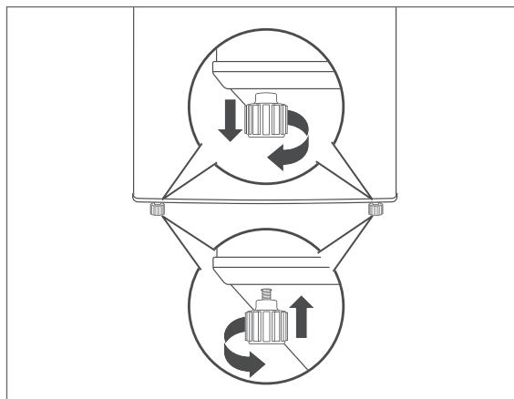
2. Gleichen Sie Unebenheiten im Untergrund mithilfe der beiden vorderen Schraubfüße aus.
