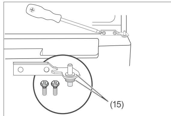
6. Schrauben Sie das mittlere Scharnier ab und nehmen Sie es heraus. Achten Sie dabei auf die Kunststoff-Scheiben (15). Sie müssen später wieder an der gleichen Position angebracht werden.
