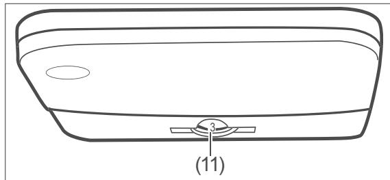
Der Temperatur-Reglers (11) dient auch zum Ein- und Ausschalten des Geräts. Er befindet sich oben im Kühlbereich.
