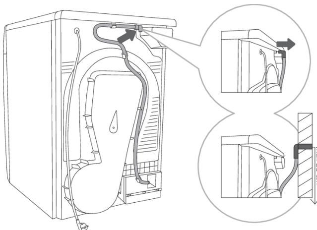
**1** Hebeln Sie mit einem Schraubenzieher den Schlauch aus dem Stutzen auf der Rückseite des Geräts (links unter der Abdeckung) heraus.
