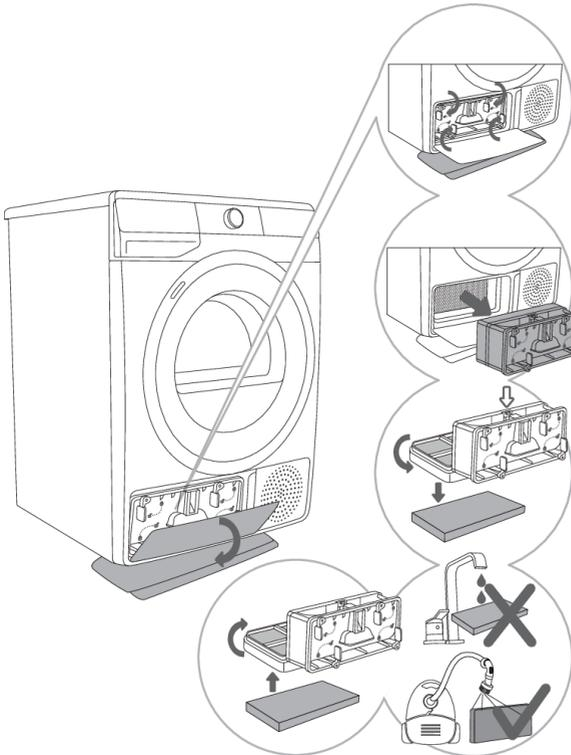
**1** Öffnen Sie die Außenabdeckung. Halten Sie die Hebel an der Innenabdeckung und drehen Sie sie, wie durch die Pfeile angezeigt.
