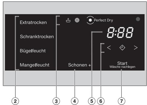
Die Sensortasten ②, ④, ⑥ und ⑦ reagieren auf Berührung mit den Fingerspitzen. Die Auswahl ist möglich, solange die jeweilige Sensortaste beleuchtet ist.
