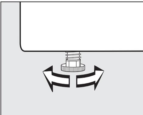
Durch Drehen der Schraubfüße werden Bodenunebenheiten ausgeglichen.
