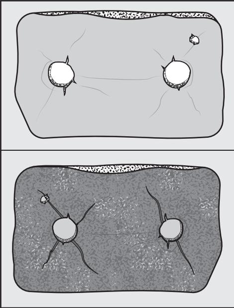
Durch Risse und Spalten werden Flusen in den Wärmetauscher geblasen. Hierdurch verstopft der Wärmetauscher auf Dauer.
