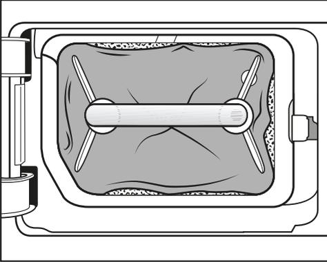
Die Ränder des Sockelfilters liegen nicht an und der Sockelfilter ist verformt. An den nicht richtig anliegenden Rändern werden Flusen ungefiltert in den Wärmetauscher geblasen. Hierdurch verstopft der Wärmetauscher auf Dauer.
