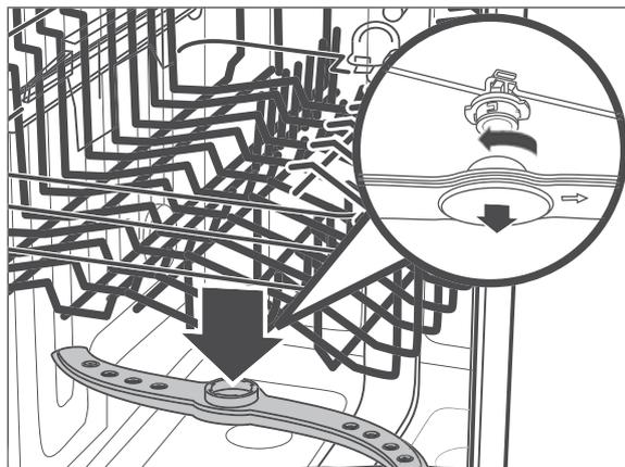
3. Der obere Sprüharm ist mit einem Bajonett-Verschluss befestigt. Zum Abnehmen halten Sie den Bajonett-Verschluss fest und lösen Sie den Sprüharm durch Drehen im Uhrzeigersinn.
