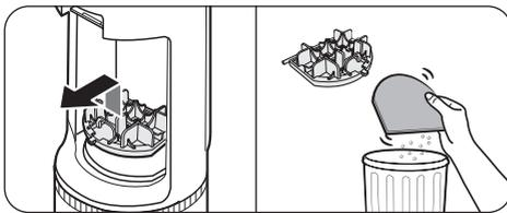
Ziehen Sie den Filter am Griff heraus und schütteln Sie ihn über einem Mülleimer aus, um den Staub zu entfernen.
