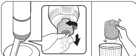
Schütteln Sie den Feinstaubfilter über einem Behälter aus, um den Staub zu entfernen.
