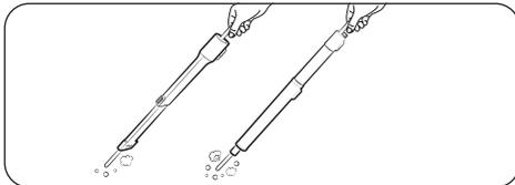
Führen Sie ein langes dünnes Stäbchen ein und drehen Sie es mehrmals, um die Verlängerungsflachdüse oder das Teleskoprohr zu reinigen.
