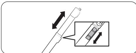
Drücken Sie die Taste zum Einstellen der Rohrlänge, um das Teleskoprohr zu verlängern oder zu verkürzen.
