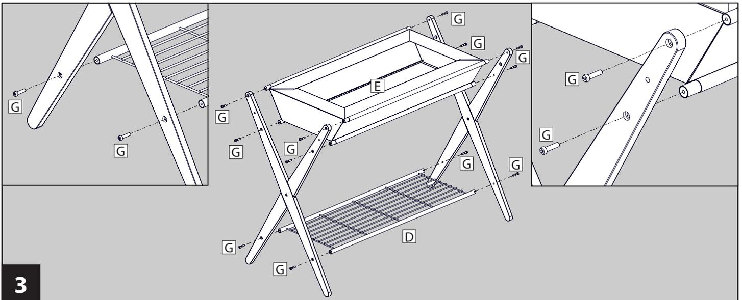
Befestigen Sie die Blumentasche **E** und die Ablage **D** mittels Innensechskantschrauben **G** an den vormontierten Standfüßen.
