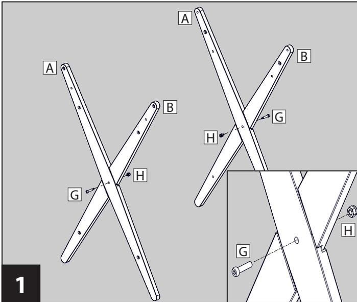
Verbinden Sie je einen Standfuß außen **A** mit einem Standfuß innen **B** mittels Innensechskantschraube **G** und selbstsichernden Mutter **H**.
