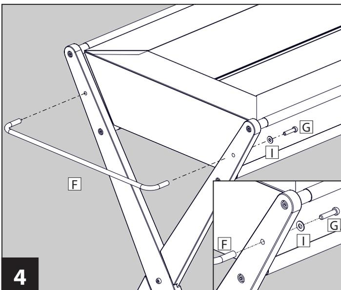
Befestigen Sie die Halter **F** mit den Innensechskantschrauben **G** und Unterlegscheiben **I**.
