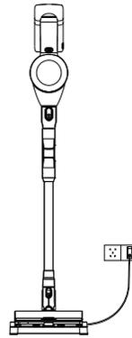
Setzen Sie das Gerät auf die Lade-Dockingstation und schließen Sie diese an eine Steckdose an.
