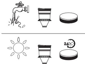
Der Feinfilter kann bei Bedarf unter kaltem fließenden Wasser gereinigt werden. Er muss vor dem Einsetzen vollständig trocken sein.
