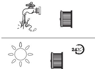
Der HEPA-Filter kann bei Bedarf unter fließendem Wasser gereinigt werden. Er muss vor dem Einsetzen vollständig trocken sein.
