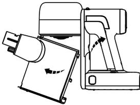
Drücken Sie die Entriegelungstaste für den Staubbehälter nach außen, um den Staubbehälter vom Gerät zu lösen.
