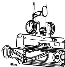
Drehen Sie bei ausgeschaltetem Gerät den Knopf an der Rollenabdeckung und ziehen Sie die Bürstenrolle heraus.
