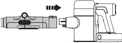
Schließen Sie das Rohr am Hauptgerät an.
