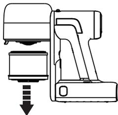
Ziehen Sie den HEPA-Filter zur Reinigung heraus. Nehmen Sie das Gerät nicht ohne zuvor eingesetzten HEPA-Filter in Betrieb.
