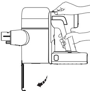
Drücken Sie die Entriegelungstaste für den Staubbehälter oben auf dem Gerät, um den Inhalt zu entleeren.
