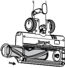
Setzen Sie die Bürstenrolle wieder vollständig in die Bürstenöffnung ein und drehen Sie den Knopf im Uhrzeigersinn, bis sie wieder sicher hörbar einrastet.
