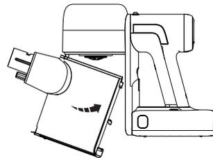
Setzen Sie den sauberen Filter nach der Reinigung wieder in das Gehäuse ein und setzen Sie dann den Staubbehälter ein. Um den Staubbehälter einzusetzen, rasten Sie zunächst den Haken an der Vorderseite des Hauptgeräts ein und schieben ihn dann vollständig in die verriegelte Position. Der Staubbehälter rastet hörbar ein, wenn er ordnungsgemäß installiert ist. Um zu überprüfen, ob er sicher sitzt, ziehen Sie ihn zur Bestätigung, dass die Installation abgeschlossen ist, vorsichtig nach außen.
