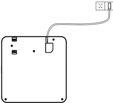
Schließen Sie den Adapterstecker am Ladeanschluss auf der Unterseite der Dockingstation an.
