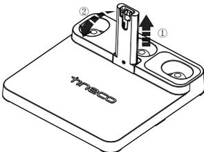
Ziehen Sie zur einfachen Aufbewahrung ziehen Sie die Ladesäule nach oben und klappen Sie sie dann nach unten.
