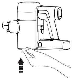
Schließen Sie die Staubbehälterklappe und lassen Sie sie einrasten.
