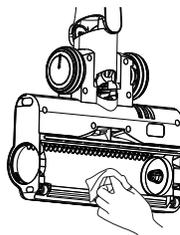
Reinigen Sie nach dem Entfernen der Bürstenrolle vorsichtig die Bürstenöffnung, die Saugöffnung und die Kunststoffzahnreihe.
