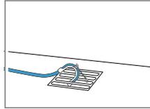
Den Wasserabflussschlauch komplett durch den Krümmer schieben und mit dem Befestigungsmaterial fixieren.
