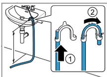
Den Wasserabflussschlauch komplett durch den Krümmer schieben und mit dem Befestigungsmaterial fixieren.
