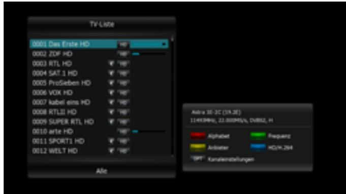
Sie können mit der Mode (🎵/📺) Taste zwischen Radio- und TV-Kanälen hin- und herschalten. Die Symbole hinter den Kanalnamen zeigen an, ob der Kanal verschlüsselt oder gesperrt ist.
