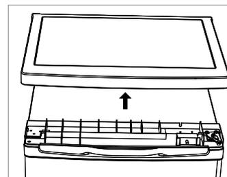
5. Drehen Sie die drei Befestigungsschrauben der Scharnierplatte und die beiden einzelnen Schrauben auf der gegenüberliegenden Seite heraus. Verwenden Sie dafür einen 8er Schlüssel oder einen Kreuzschlitz-Schraubendreher. Nehmen Sie die Scharnierplatte ab.
