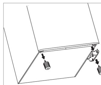
12. Versetzen Sie den Scharnierbolzen auf die gegenüberliegende Seite der Scharnierplatte. Verwenden Sie zum Lösen und Festziehen der Mutter einen 10er Schlüssel oder die Unterseite eines Stellfußes.
