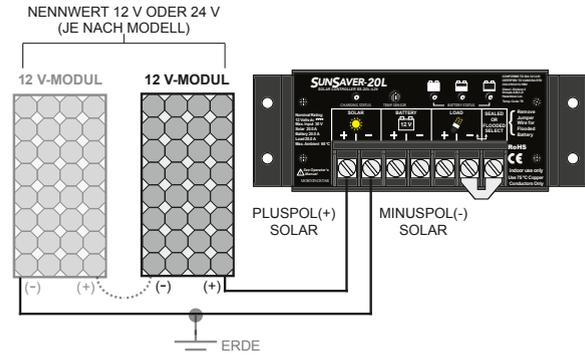
Abbildung 6. Anschluss Solareingang.
