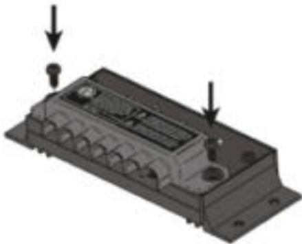
Abbildung 8c. Befestigen der Klemmenblende mit 2 Schrauben.
