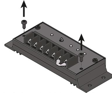
Abbildung 8a. Entfernen der 2 Schrauben der Blende.
