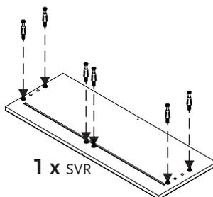
! • Verbinden Sie die Schubkastenteile zunächst nur lose miteinander. Ziehen Sie die Schrauben erst fest, nachdem Sie sich davon überzeugt haben, dass die Schubkastenseiten im rechten Winkel montiert sind.
