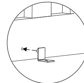
! • Bitte Lattenrost mit Klammern/Schrauben nach oben montieren. Erst Lattenrost auf die Lattenrostträger legen und dann mit Schrauben befestigen.
