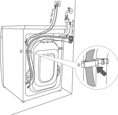
**D** Der Ablaufschlauch muss auf den Stutzen an der Rückseite der Waschmaschine eingesteckt und befestigt werden, wie auf der Abbildung dargestellt.
