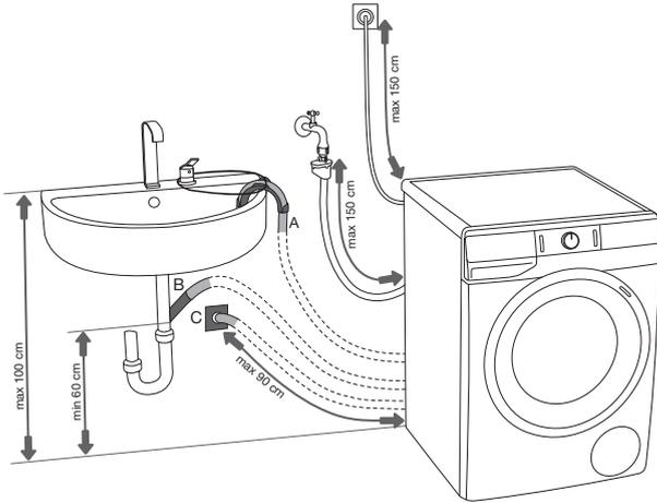
**A** Sie können den Ablaufschlauch direkt in ein Waschbecken oder in die Badewanne stellen. Befestigen Sie den Ablaufschlauch mit einer Schnur durch die Öffnung im Winkelstück, damit er nicht auf den Boden rutscht.
