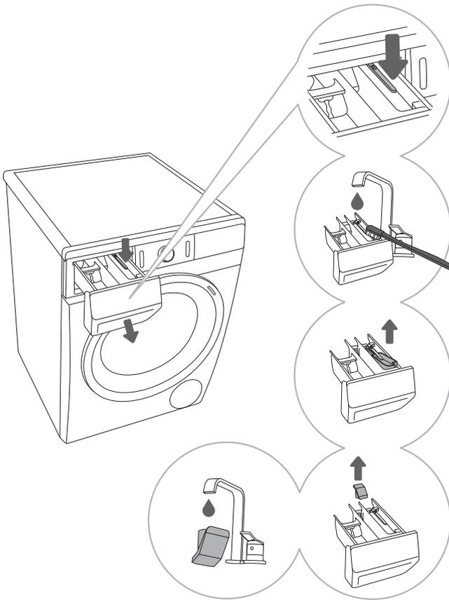
**1** Sie können den Dosierbehälter durch Drücken des Dornes aus dem Gehäuse herausnehmen.
